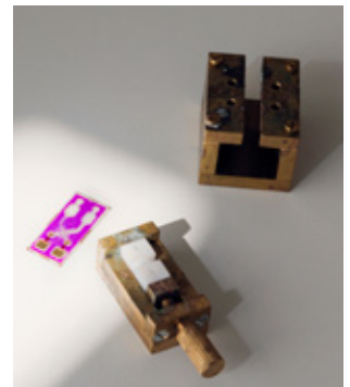
Verschiedene Entwicklungsstufen der Messkammer, die die Miniaturisierung demonstrieren.
