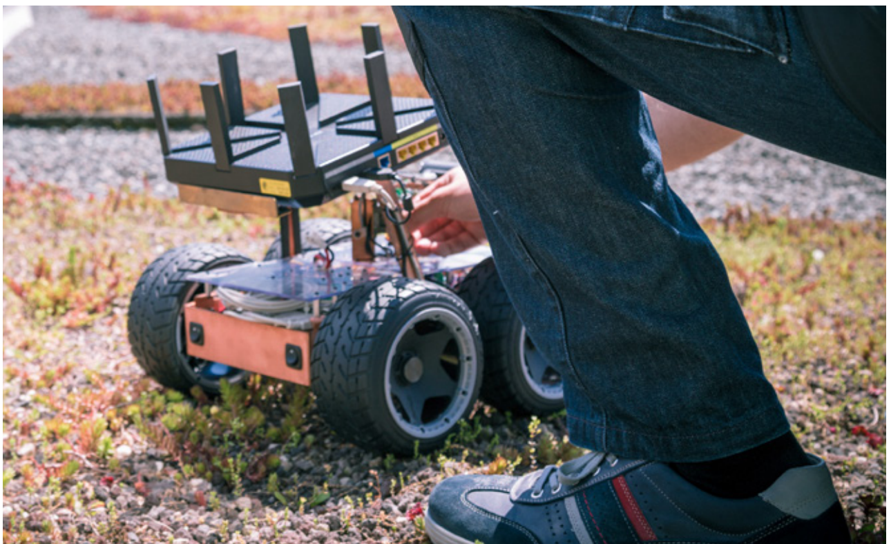
Offene Testplattform für Millimeterwellenkommunikation auf Basis einer modifizierten, handelsüblichen Basisstation.
